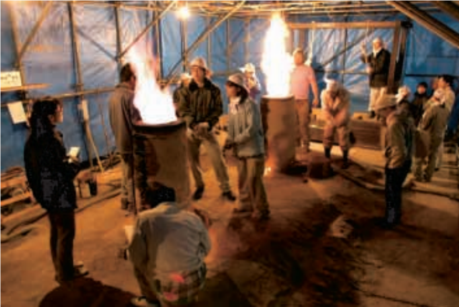
古墳時代製鉄炉の復元操業（愛媛大学）
