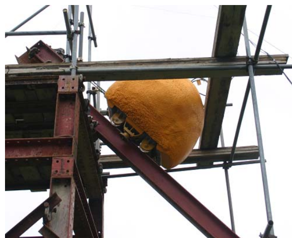
写真2 車輪が付いた重さ 2 トンのコンクリート製の重錘
