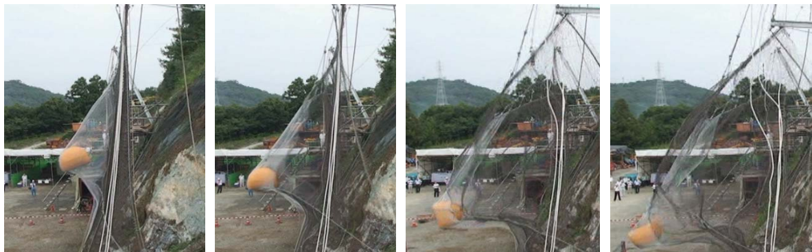
写真11 ネットに衝突した重錘が回転運動をする様子
