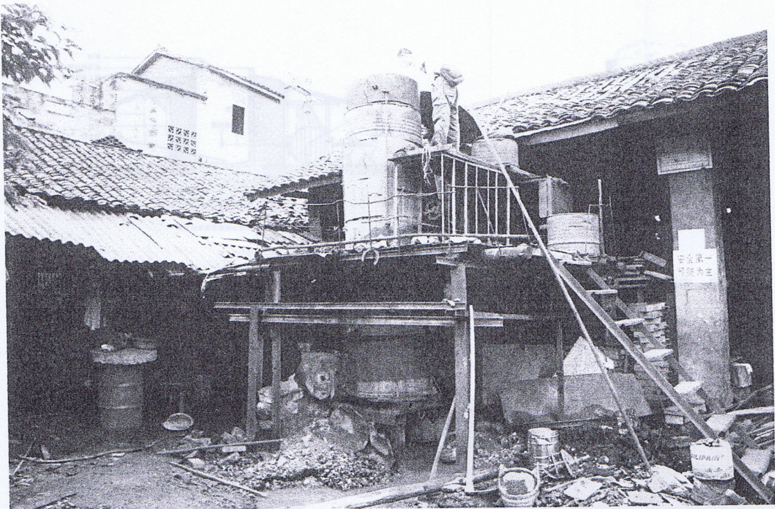
図 14 四川・邛崃で現在稼働中の鑄造炉
